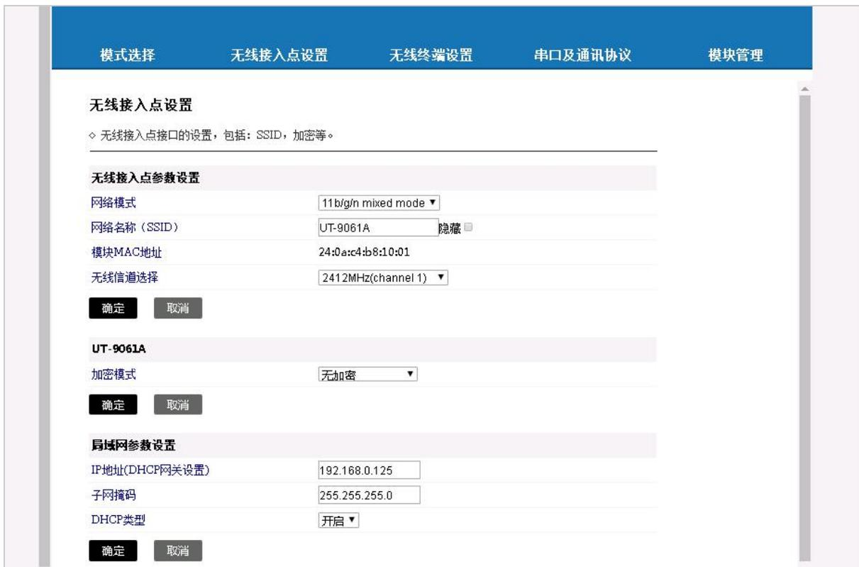
图 3、无线接入点设置
